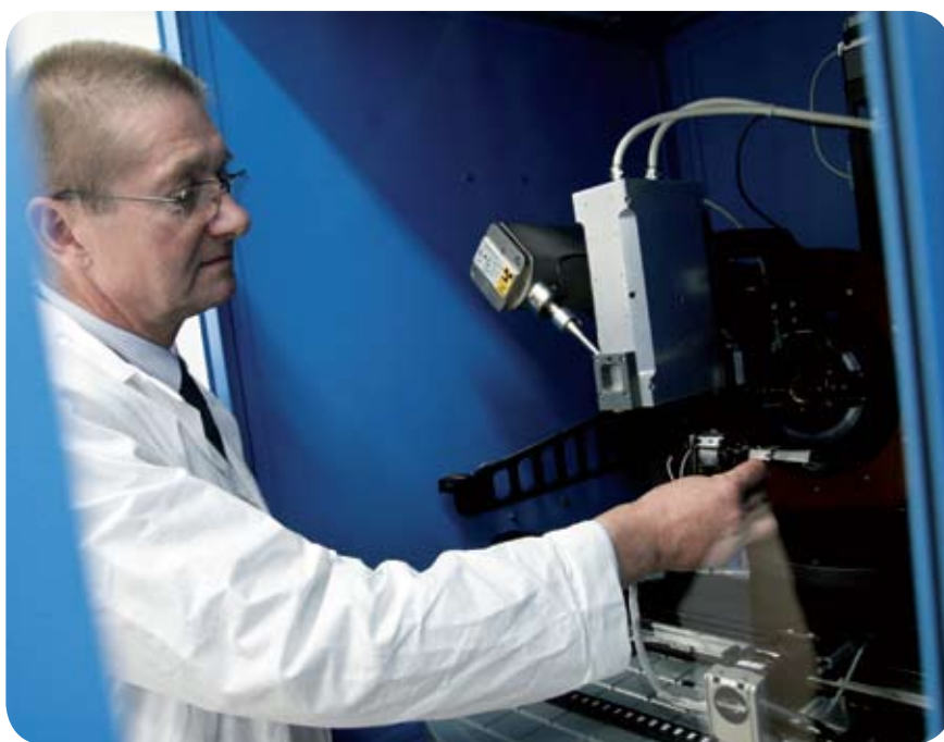
Prof. Krzysztof Kubiak wykonuje badania z wykorzystaniem unikalnej aparatury do określenia orientacji monokryształu
