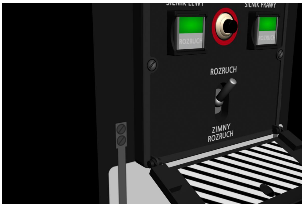
Rys. 7 Pulpit rozruchu silnika w trakcie procesu rozruchu
