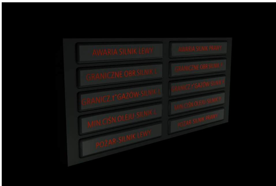
Rys. 14 Panel kontrolki awaryjnych. Kontrolki zapalone
