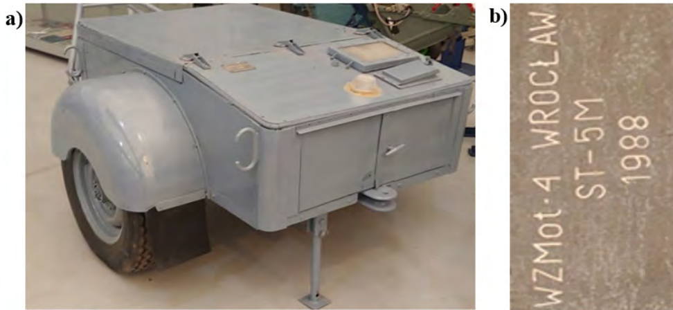
Rys. 1. Akumulatorowy wózek rozruchowy St-5M: a) widok ogólny; b) tabliczka wytwórcy
