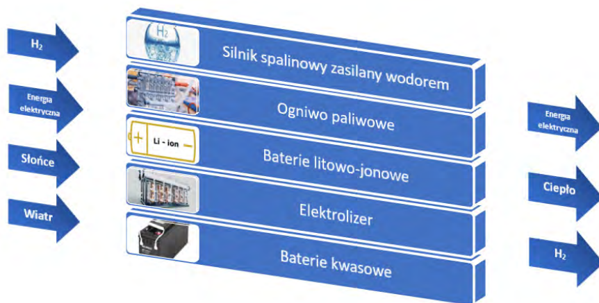
Rys. 1. Schemat blokowy interaktywnego magazynu energii (opracowanie własne)
