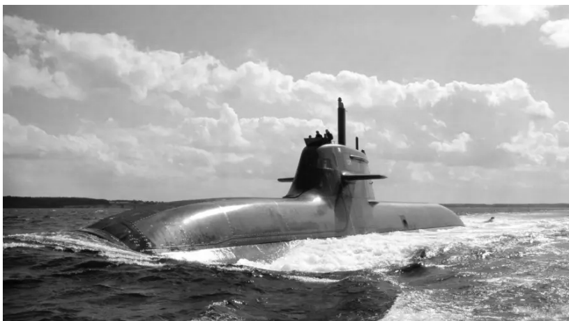
Rys. 2. Okręt podwodny HDW klasy 212A z metanolowym ogniwem paliwowym [Okretypodwodne.edu.pl 2024]
