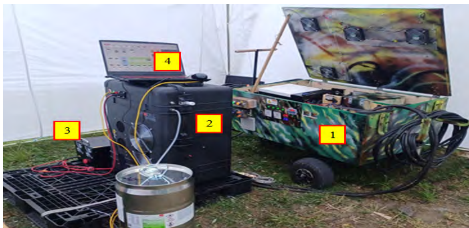
Rys. 7. MPSZE-3 z koreańskim źródłem metanolowym (DMFC) oraz falownikiem i laptopem z oprogramowaniem do zapewnienia monitoringu: 1 – MPSZE-3 przystosowana do współpracy z koreańskim źródłem metanolowym; 2 – źródło metanolowe (DMFC) typ DM1500; 3 – falownik; 4 – laptop z oprogramowaniem do zapewnienia monitoringu
