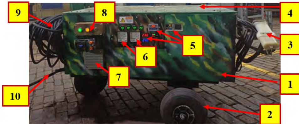
Rys. 2. Widok ogólny MPSZE-6 – wózek rozruchowy: 1 – korpus wózka rozruchowego; 2 – koło jezdne (koło przednie ze śmigłowca Mi-2); 3 – wtyczka SzRAP-50 na końcu kabla wydawczego prądu stałego; 4 – pokrywa wózka rozruchowego; 5 – wskaźniki cyfrowe: moc czynna/bierna, współczynnik mocy; 6 – mierniki wychyłowe (woltomierz/amperomierz prądu stałego); 7 – kratka kanału wentylacyjnego; 8 – centralny włącznik; 9 – kabel do połączenia jednostki centralnej z panelami fotowoltaicznymi
